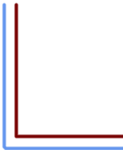
-15, 'quad_segs=4 join=round' 元のラインと -15 単位ずらしたライン
