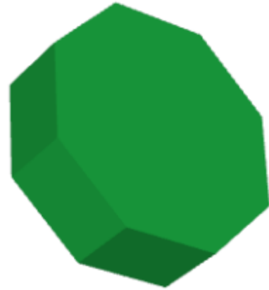
Ein Achteck, um 30 Einheiten entlang der Z Achse ausgeweitet, ergibt ein PolyhedralSurfaceZ
